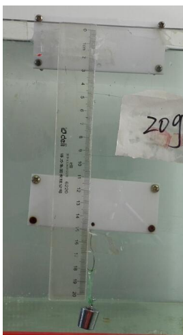
图 1.3 拉伸法测定杨氏模量示意图
